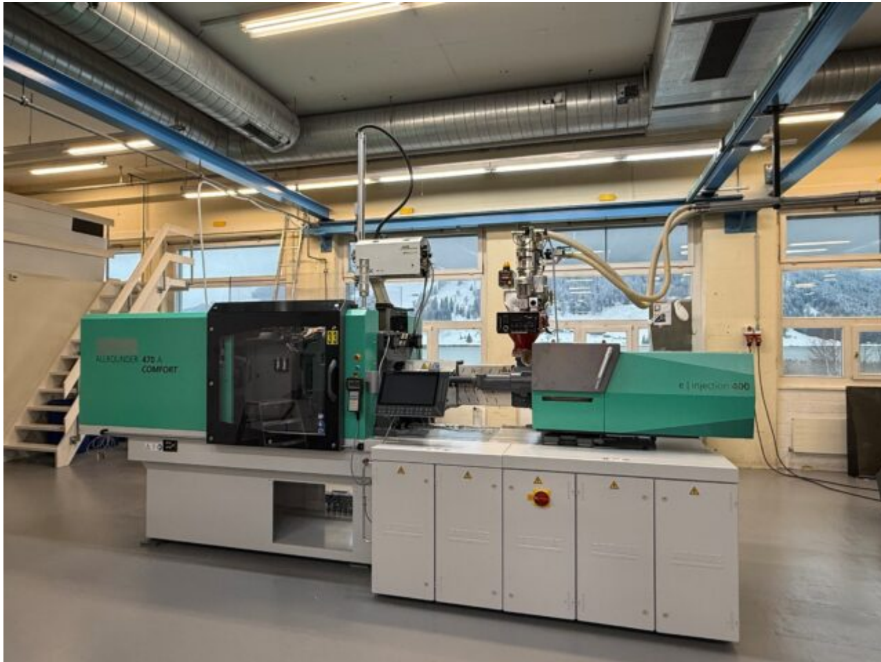
Foto: Energieeffiziente Arburg Spritzgussmaschine mit innovativem Rezyklat-Paket
