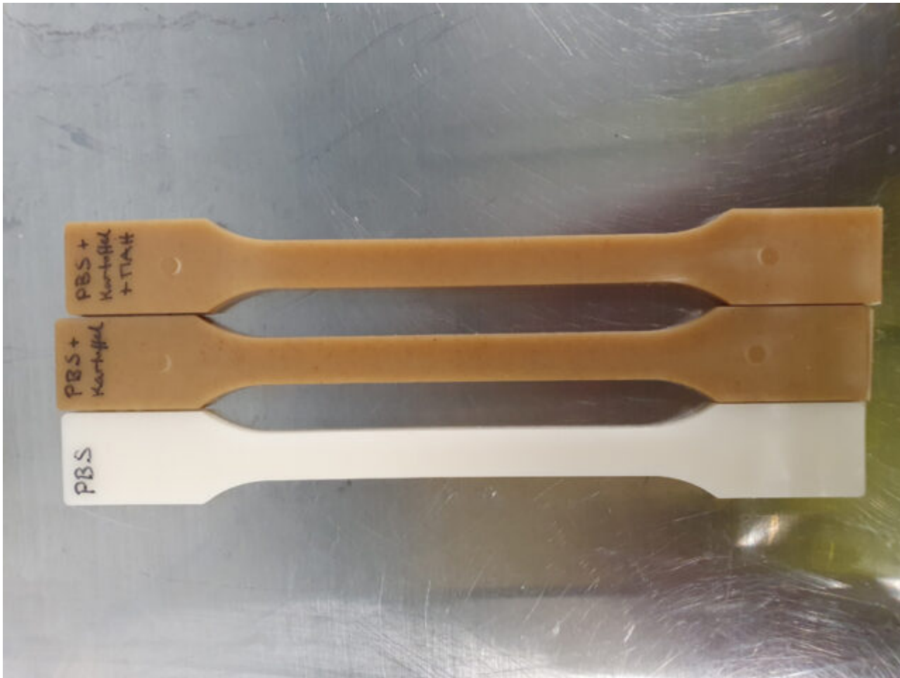
Schulterstäbe aus PBS (unten) sowie aus Kartoffelschalencompounds (oben)
