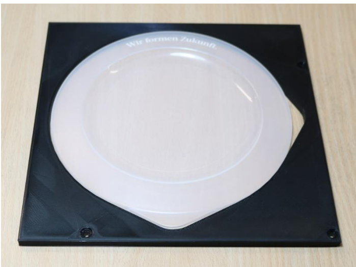
Schablone / Aufnahme für einen flexiblen Deckel einer Mehrweg-Bowl mit zwei Positionierungsmöglichkeiten; gedruckt auf dem Ultimaker S5 mit Ultimaker Tough PLA Schwarz.
