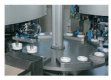
In den Drehverschluss wird eine Dichtungseinlage automatisch eingeklebt. Für ganz heikle Produkte kann zusätzlich eine Trockenmittelkapsel eingeleimt werden, um Feuchtigkeit zu absorbieren.
