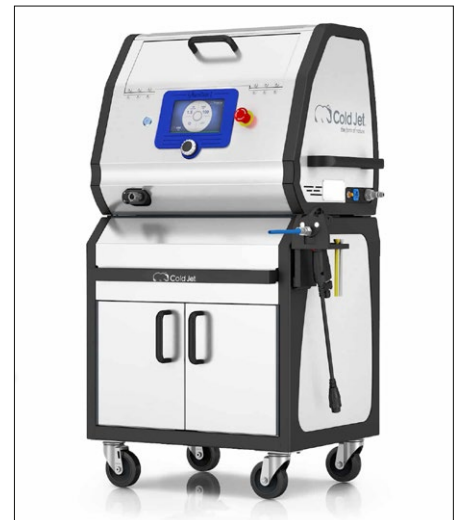
Die i3 MicroClean 2 von Cold Jet verwendet eine patentierte (Block-Shaver) Technologie, bei der recyceltes CO 2 in Form von festen Mikro-Trockeneispartikeln mit hoher Geschwindigkeit auf die Oberfläche gestrahlt wird.
